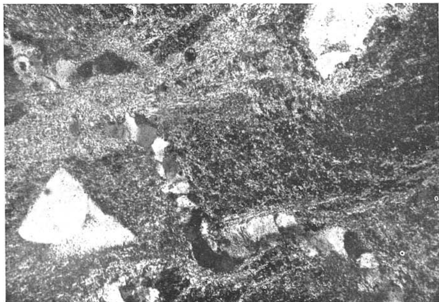
Obr. 2. Pruhy sericitu obtekajúce výrastlice kremeňa u porfýroidov a laterárne sekre- cionálna žilka prerážajúca horninou. Foto Šilhanová.
